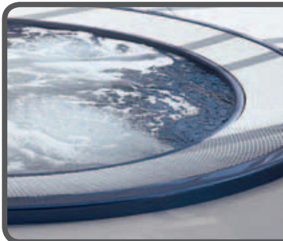
Una caratteristica distintiva della gamma Professional e Profile Pro è la griglia inclinata di 15° lungo il perimetro della spa. L'acqua di superficie che fuoriesce dal bordo viene raccolta attraverso la griglia in una vasca di compenso. L'acqua passa quindi attraverso un sistema di filtraggio, e viene pulita e pompata nuovamente verso la base della spa per essere riutilizzata.
