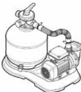
Il filtro a sabbia optional assicura nel tempo igiene e pulizia, perché intrappola le impurità nell'acqua. Facile da togliere, deve essere pulito regolarmente e sostituito quando necessario.
